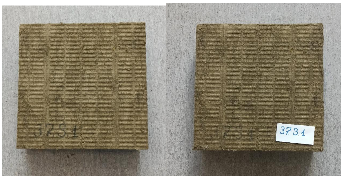
Рис. 2.10 Вид образца марки IZOLIFE ВЕНТ ЭКСТРА до (слева) и после (справа) прохождения 30 циклов замораживания и оттаивания
