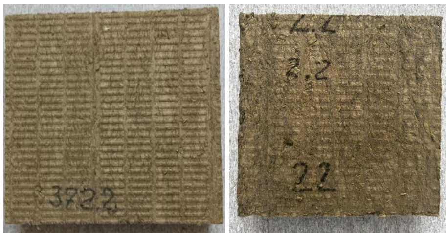
Рис. 3.4 Вид образцов IZOLIFE ВЕНТ СТАНДАРТ до (слева) и после (справа) 105 суток испытаний в установке
